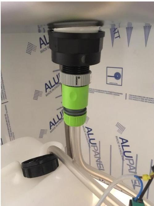
6. Wasserhahn ins vorgeborte Loch so in Position bringen, dass der Wasserschlauch von unten an die blaue Windung gesetzt werden kann.
