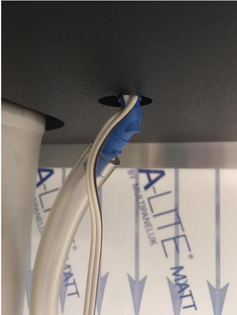
Um den Schlauch am blauen Gewinde kann die Drehschraube befestigt werden, sodass der Schlauch nicht rutscht.
